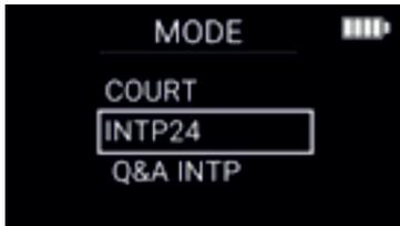
1. Vergewissern Sie sich, dass Sie denselben Modus wählen wie das MASTER-Gerät des Digi-Wave®-Systems. Wenn die Modi nicht übereinstimmen, kann sich das Steuergerät nicht mit dem Master-Gerät synchronisieren.
