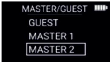
Diese Auswahl wird normalerweise für den Moderator empfohlen. Master 2 ist optional, ermöglicht es aber dem Moderator, seine TALK-Taste immer eingeschaltet zu haben, ohne zu riskieren, dass er abgeschaltet wird, wenn zu viele offene Mikrofone im System vorhanden sind.
